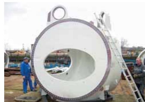
FOTO ROTORNABE: MIT FREUNDLICHER GENEHMIGUNG DER REPOWER SYSTEMS AG
